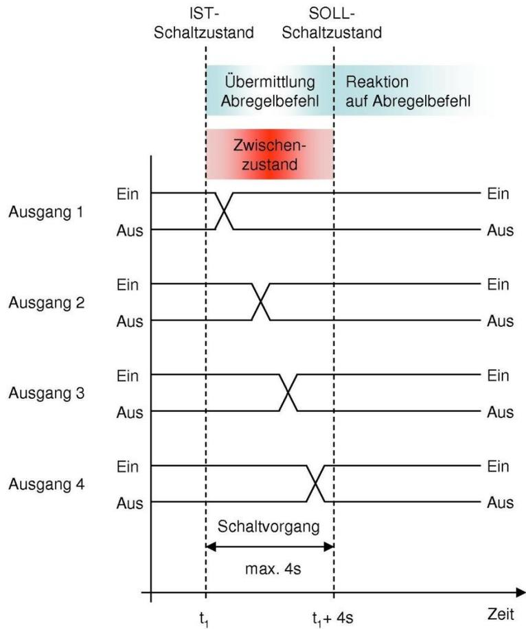
**Bild 3** Schaltcharakteristik des Schaltmoduls PRM 44
