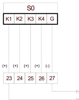
Die Zählimpulse (-A) der Verrechnungsmesseinrichtung sind in Eingang 1 (K1) einzuspeisen!
