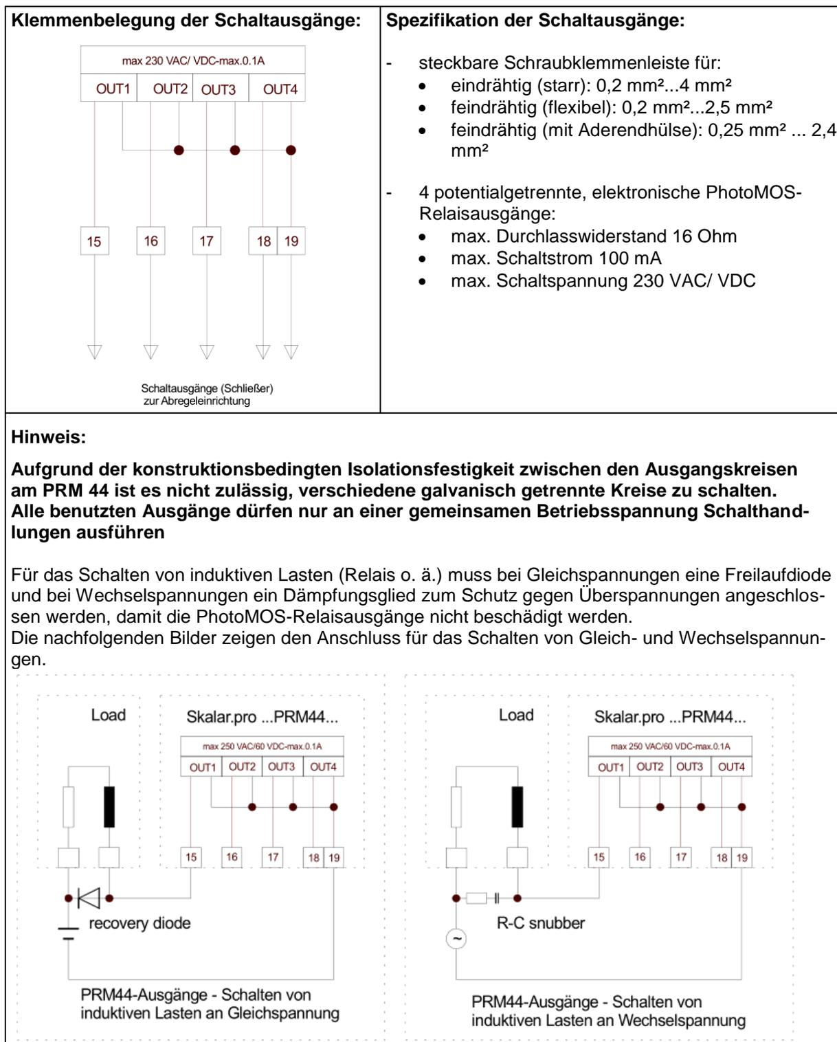
**Bild 2** Technische Ausführungen der Schaltausgänge des Schaltmoduls PRM 44
