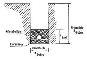
Bei einer Mindestrohrüberdeckung von 0,80 m wird eine Mindestgrabenbreite von 0,30 m vorgesehen.
