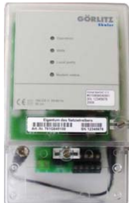
Bild 2: Kommunikationsgerät mit Schaltausgang (KSA Typ Görlitz Skalar GSM/GPRS)
